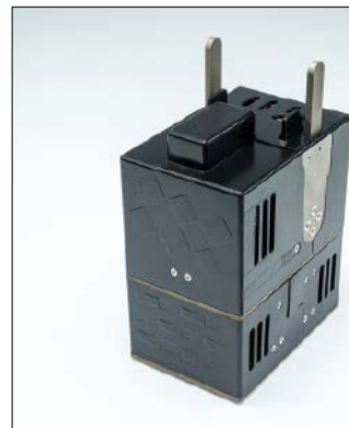
Die vom Fraunhofer IMM entwickelte Plattform umfasst einen kompakten Analyzer (A), sowie eine mikrofluidische Kunststoffkartusche, auf der eine PCR durchgeführt werden kann (B). Das System kann vollautomatisiert unter Einbindung eines Cobots genutzt werden (C).
